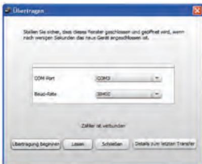
Der Zähler kann mittels des Programmierassistenten direkt vom PC programmiert werden. Hierzu ist der Zähler mittels USB-Kabel mit dem Rechner zu verbinden (kleine Buchse am Zähler). Durch anklicken des Buttons „Übertragung beginnen“ im Menü Datei\Übertragen wird die Konfigurationsdatei in den Zähler übertragen. Durch anklicken des Buttons „lesen“ wird die Konfigurationsdatei in den PC eingelesen.
