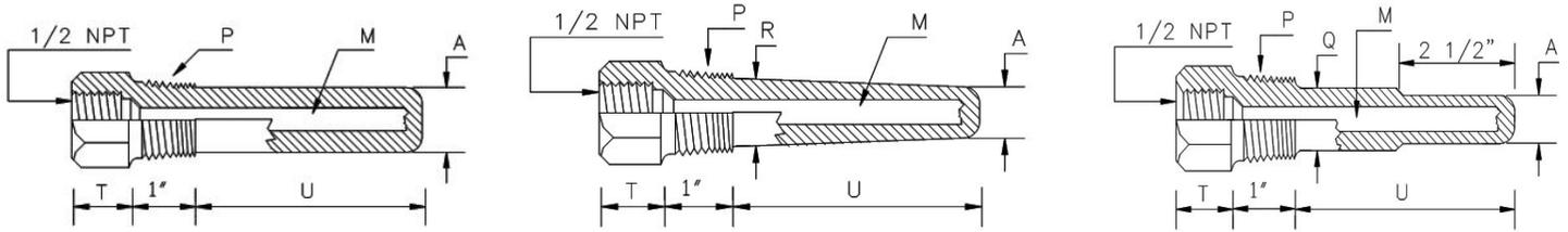
Serie: TR (Roscados) (Ejemplo, N/P: TRR1-3D4.0P3 / Para Termopar o RTD de 4" de vástago)
