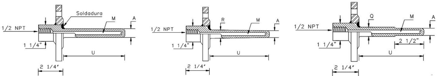
Serie: TB (Bridados) (Ejemplo, N/P: TBR1-C12.0P1 / Para Termopar o RTD de 12" de vástago)
