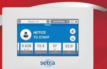
FLEX Monitor Ambiental multi-canal para áreas Críticas
